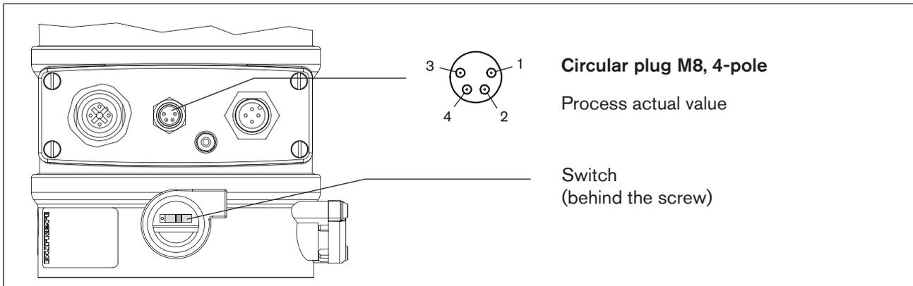
Figure 111: Connection - PROFIBUS-DP - Type 8693 - process actual value
