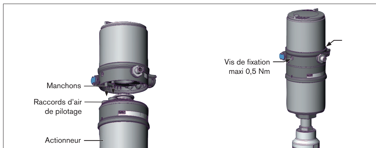
Figure 18 : Montage du positionneur, séries 2103, 2300 et 2301
